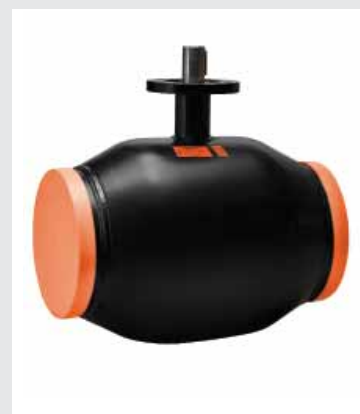
КШТ Серия 12, DN 125–500, PN 2,5 МПа Сварка / Сварка
